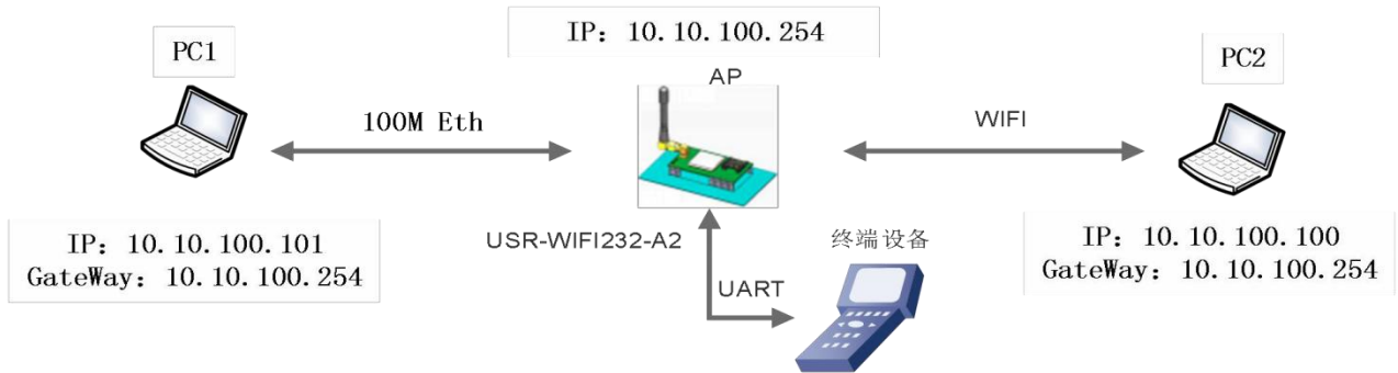
图 8 USR-WIFI232-A2 以太网接口功能（AP LAN）
