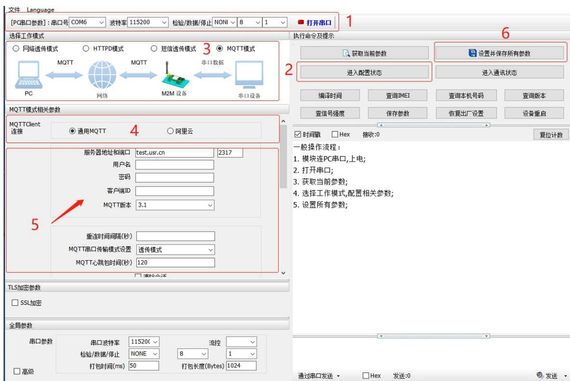
图 29. 设置软件 MQTT 模式示意图
