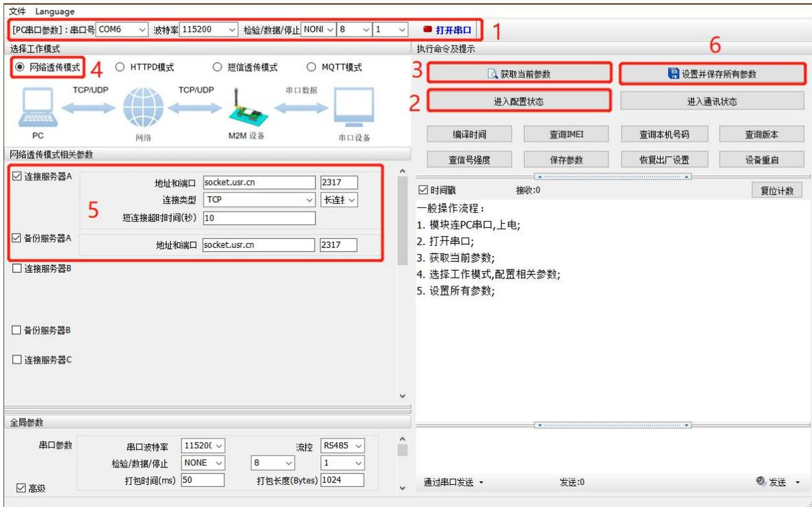
图 23. 设置软件示意图
