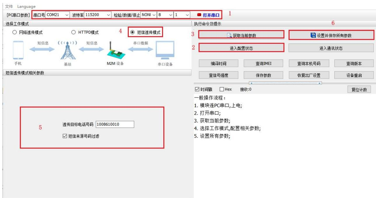
图 27. 设置软件示意图
