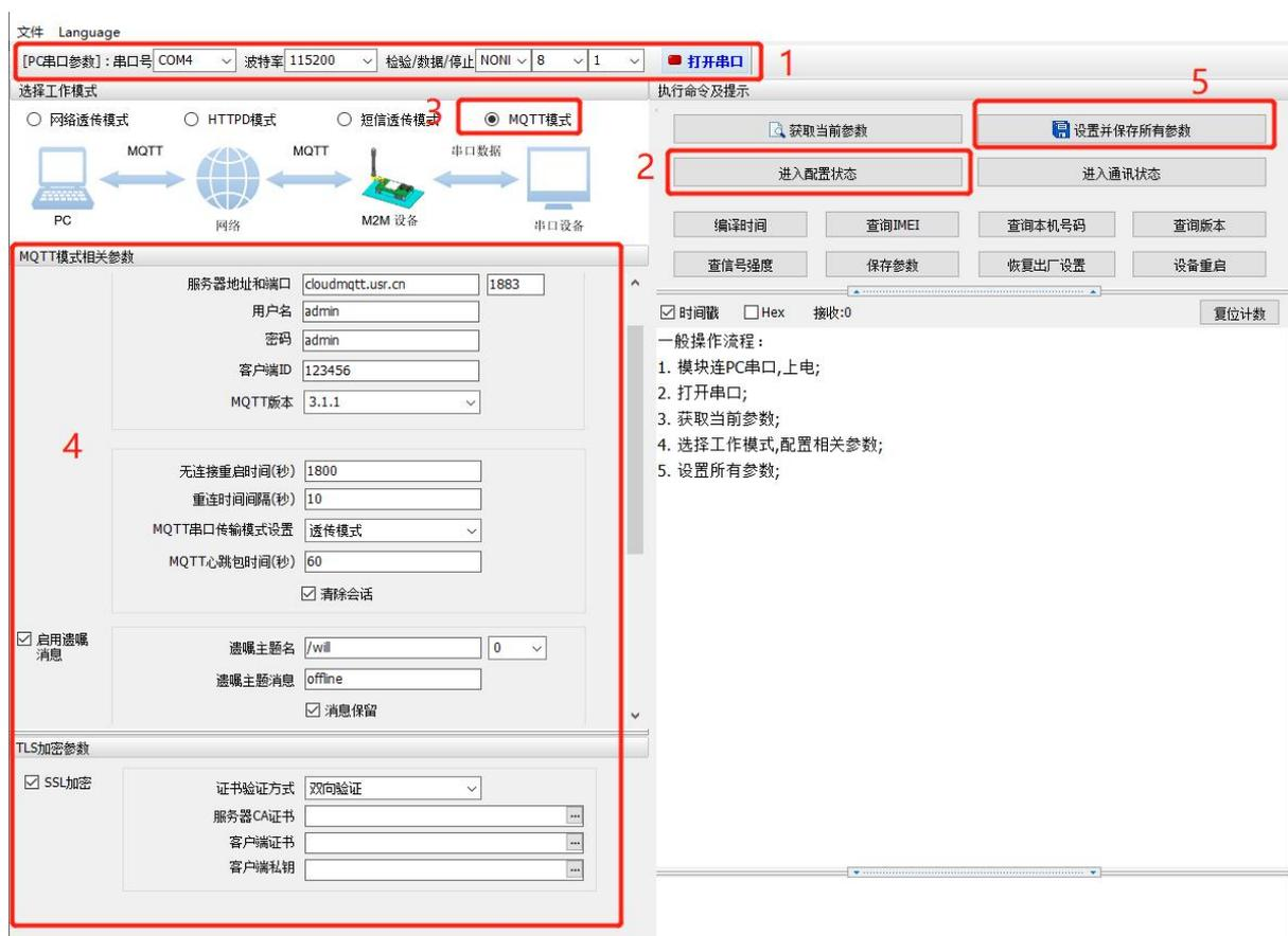
图 30. MQTT 模式通用接入方式示意图
