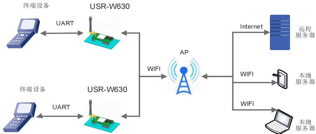
图 2 串口服务器作为 STA 的应用场景
