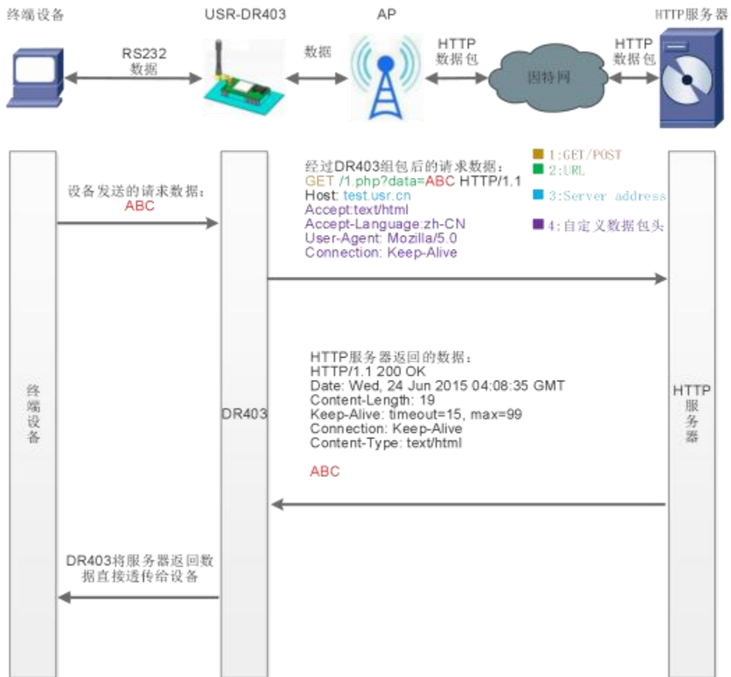
图 38 HTTPD Client 功能框图
