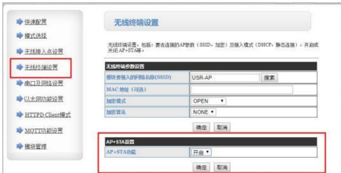
图 28 无线组网应用（AP+STA）
