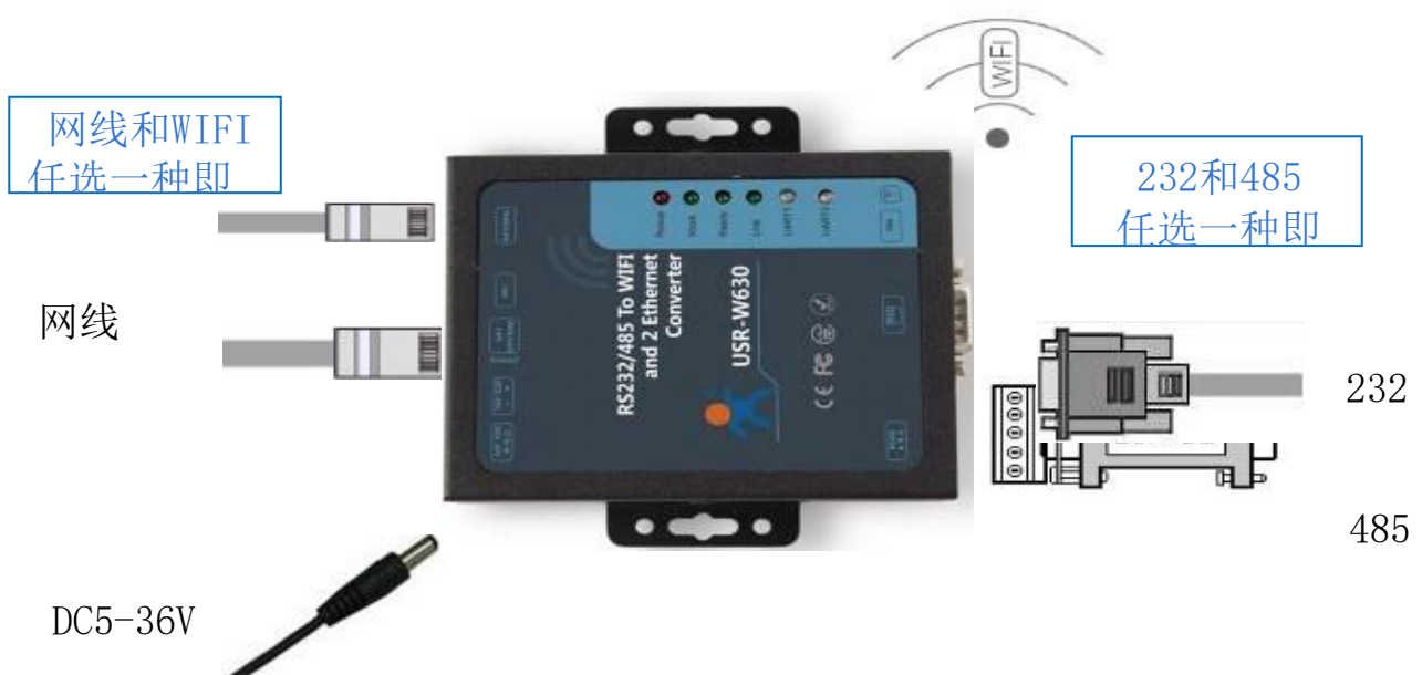
图 1 硬件连接示意图
