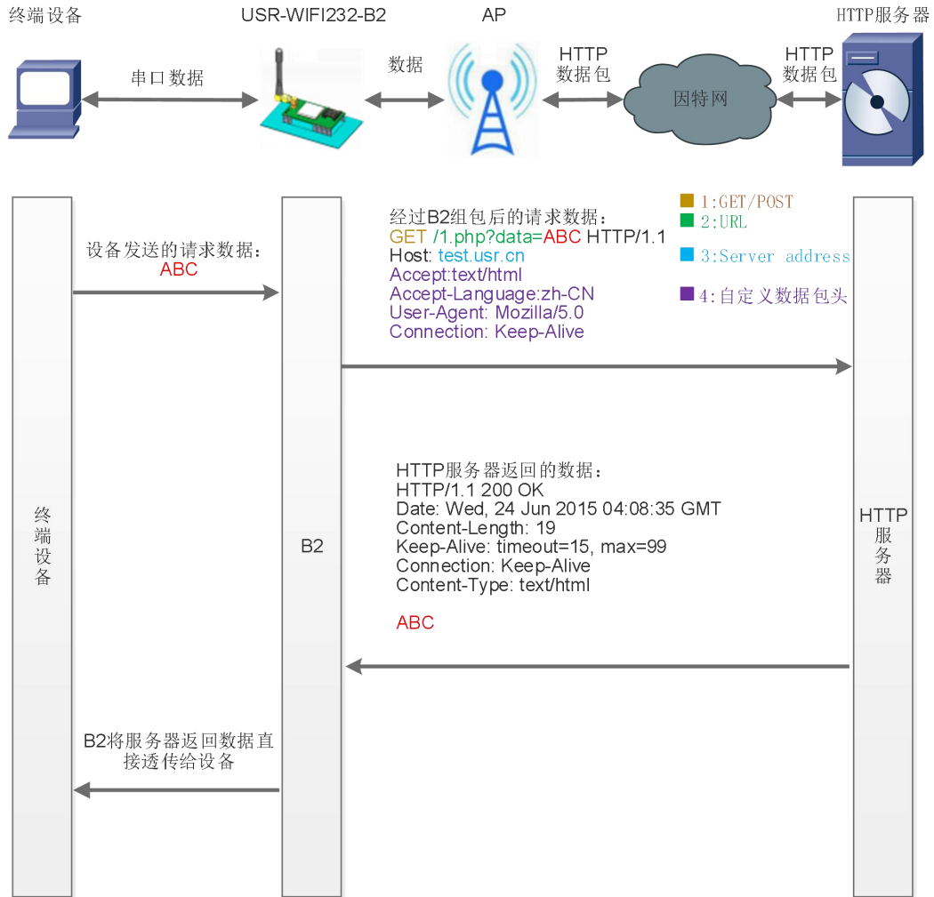
图 20 HTTPD Client 功能框图
