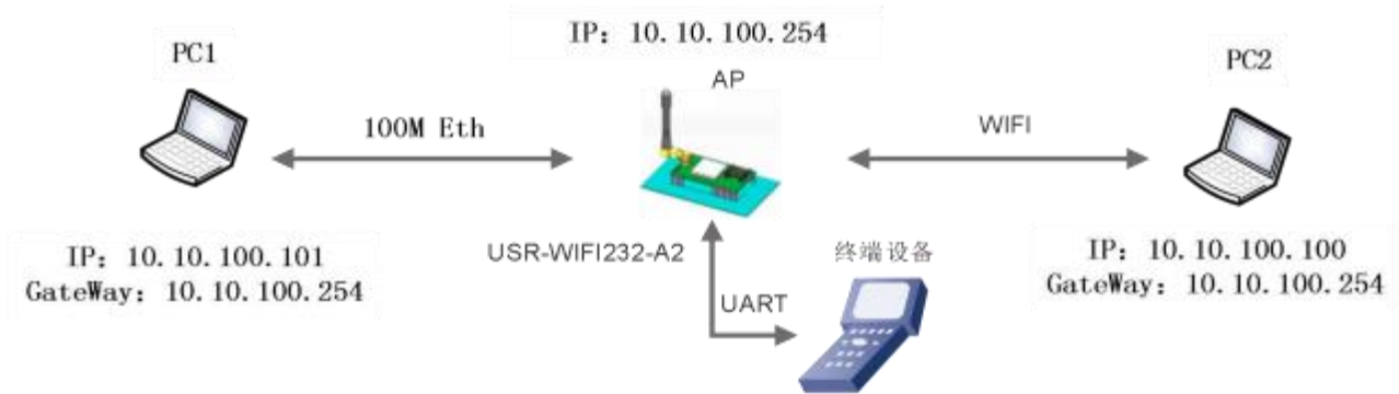
图 16 USR-WIFI232-A2 以太网接口功能（AP）
