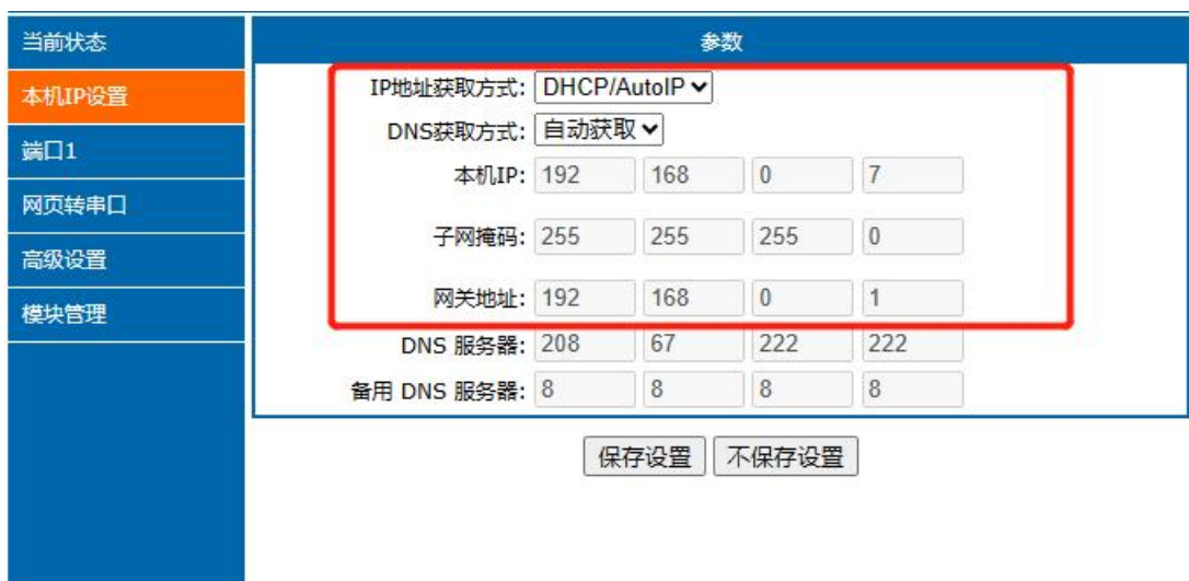
图 1 本机 IP/子网掩码/网关
