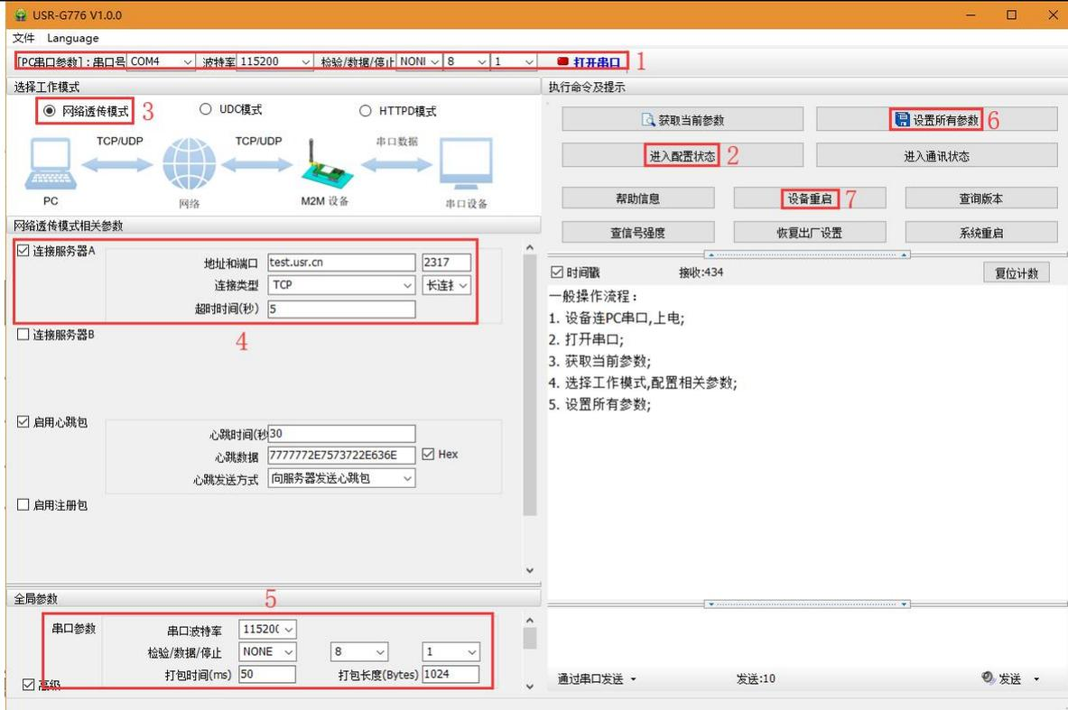
1. 打开专用设置软件“USR-G776”。根据实际情况设置串口参数并点击“打开串口”。
