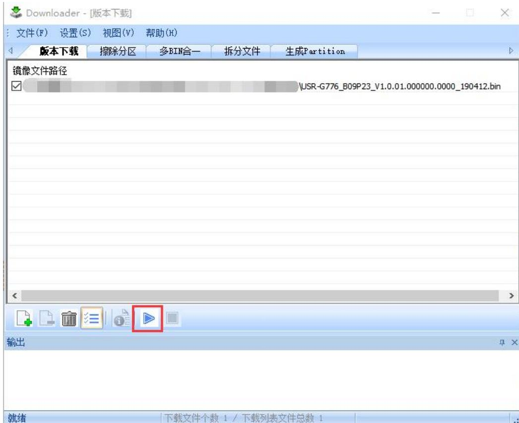
(6) 输出界面有“未检测到有效设备！等待插入设备”提示时，给 G776 上电，开始固件升级。
