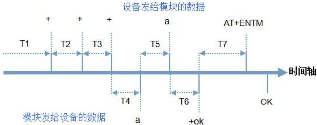
在上图中，横轴为时间轴，时间轴上方的数据是串口设备发给设备的，时间轴下方的数据为设备发给串口的。
