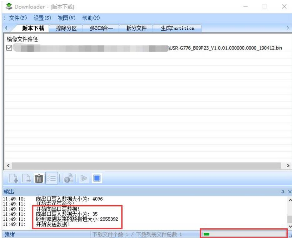
(8) 待烧录进度条完成，并有“下载完成”的提示时，表示固件下载成功，固件升级成功后，等待 work 灯亮起，然后重新上电运行。
