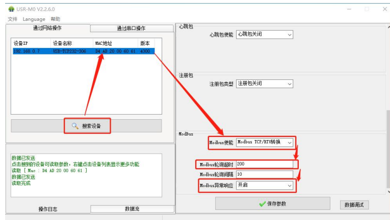
图 22. 软件设置 Modbus 协议转换
